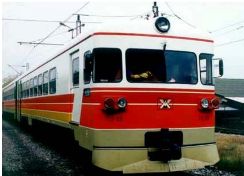
Слика 4. Дизел моторен воз (ДМВ) серија 712
