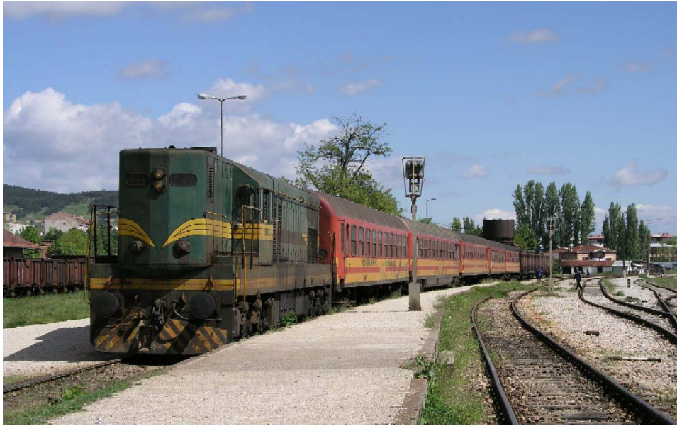
Слика 3. Класична гарнитура на воз со дизел електрична локомотива серија 661
